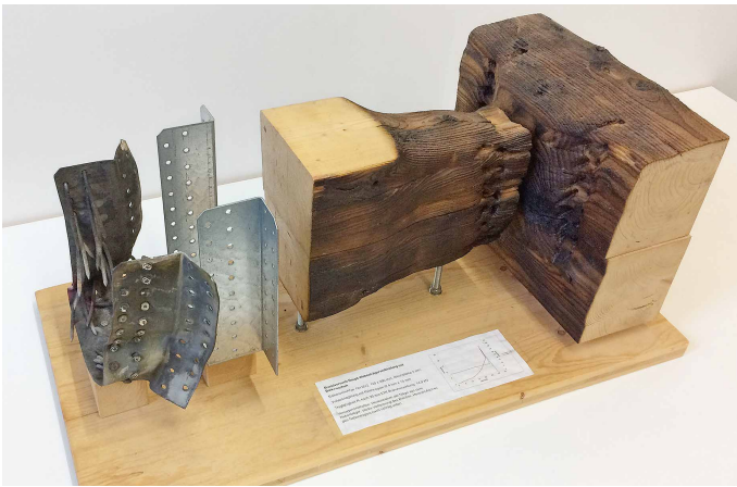
Abb. 5: Balkenschuhverbindung nach Brand- einwirkung
