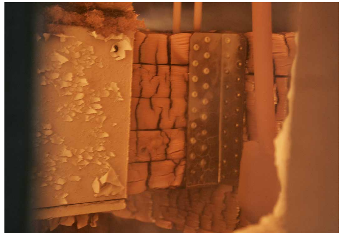
Abb 1: Balkenschuhverbindung im Brandversuch
