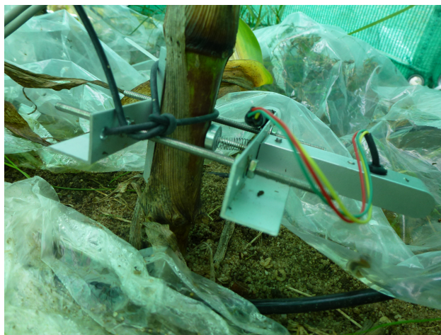
Abbildung 2.8: Installiertes Dendrometer an einer Pflanze auf einem Lysimeter in Neuherberg am 26. September 2014
