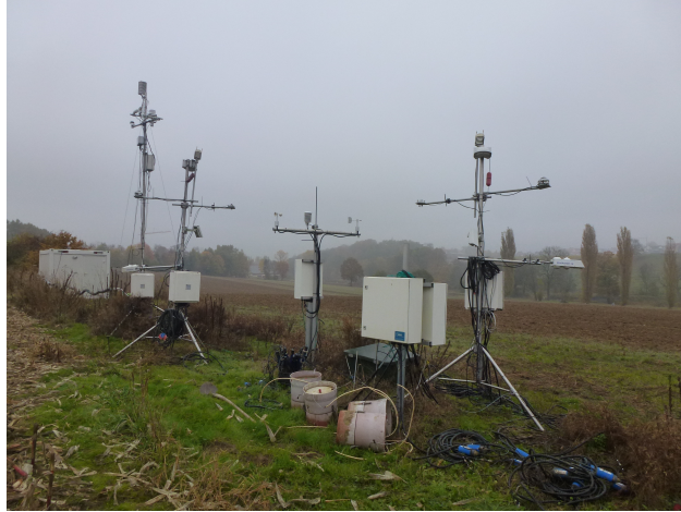
Abbildung 2.9: Eddy-Kovarianz-Station der Forschungsplattform Scheyern am 27. Oktober 2015
