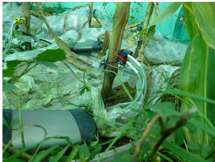
Abbildung 2.4: Installierte Saftflusssensoren, Dendrometer sowie Abdeckung des Bodens
