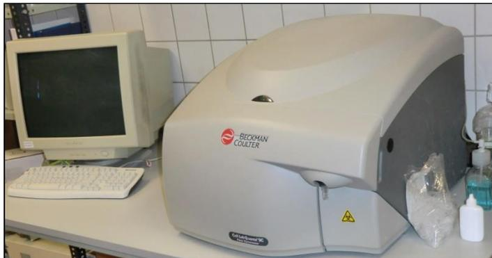
Abbildung 9: In der Arbeit verwendetes Durchflusszytometer Cell Lab Quanta SC (Beckman Coulter).
