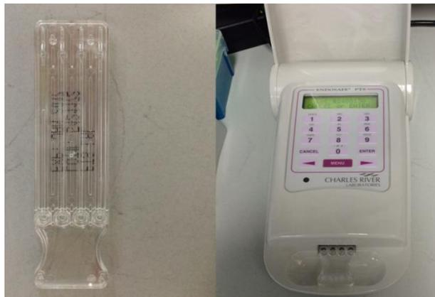
Abbildung 74: LAL-Test-Kartusche und Endosafe®-PTS-Messsystem.
