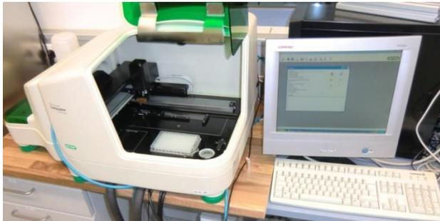
Abbildung 25: Foto des verwendeten Kontaktpotters BioOdyssey Calligrapher MiniArrayer (BioRad Laboratories).
