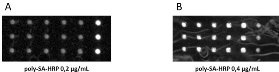
Abbildung 35 A und B: Bild der CCD-Kamera von Mikroarray-Messungen mit SA-poly-HRP-Konzentrationen von 0,2 und 0,4 µg/mL (Setup: Stammlösung: *L. pneumophila* SG 1, ST Bellingham ( $c = 6,59 \times 10^7$  KBE/mL), Detektions-Antikörper: pAb anti-*L. pneumophila*, biotinyliert ( $c = 4 - 5$  µg/mL); Fänger-Antikörper: pAb anti-*L. pneumophila*, unmarkiert ( $c = 2,5$  mg/mL); Fließgeschwindigkeit: 0,5 µl/s; Inkubationszeit: 30 s).
