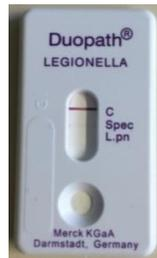
Abbildung 19: Duopath-Test von Merck KGaA mit Möglichkeit zur Detektion von *Legionella spp.* sowie *L. pneumophila*.
