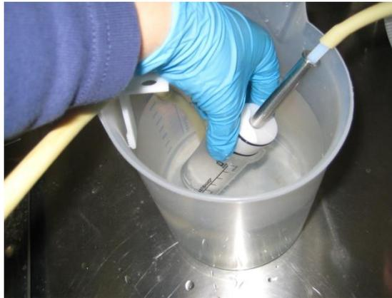
Abbildung 71: Zusammensetzen und Fixieren der MAF-Säule mit Stempel und Adapter.
