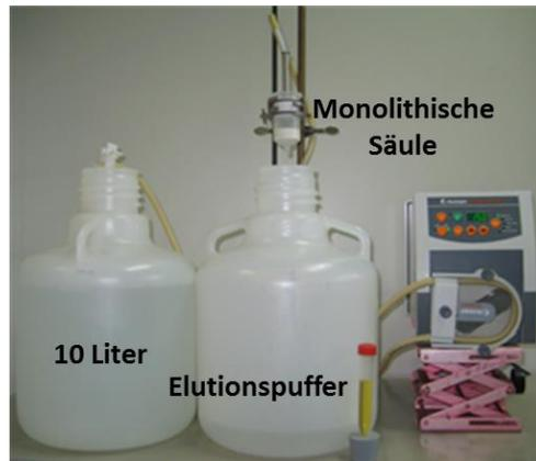
Abbildung 72: Aufbau des Filtrationsprozesses.
