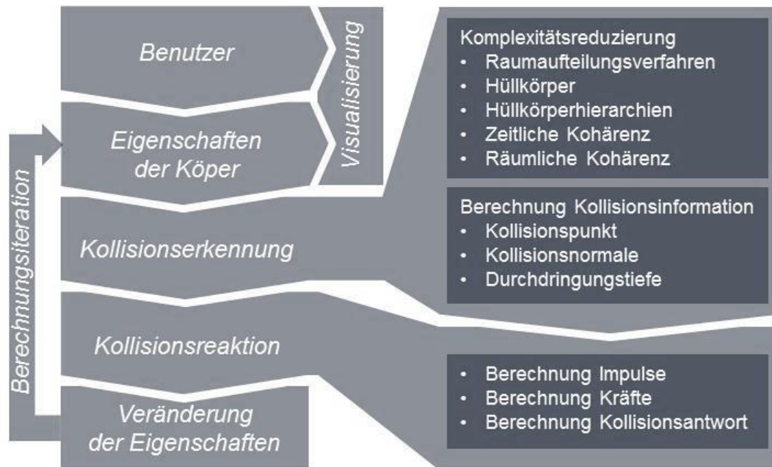
Abbildung 2.8: Ablauf einer physikbasierten Simulation (eigene Darstellung der in ERICSON 2005; SPITZWEG 2009, S. 23–41; MILLINGTON 2010; PARENT 2012; BENDER 2014, S. 84 wiedergegebenen Daten).
