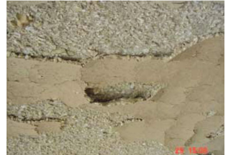
Bild 6. Tübbing mit 2 kg/m 3 Polypropylenfasern nach dem Brandversuch
