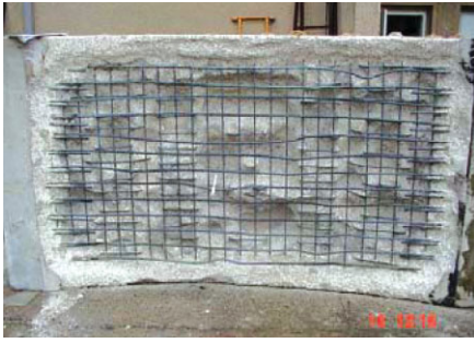
Bild 4. Tübbing ohne Polypropylenfaserzusatz nach dem Brandversuch
