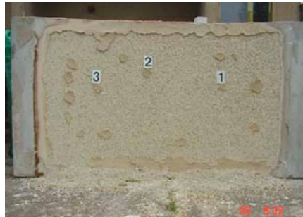
Bild 6. Tübbing mit 2 kg/m 3 Polypropylenfasern nach dem Brandversuch
