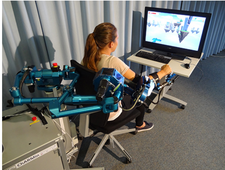
Abbildung 1.5: Modell ChARMin der Firma Sensory-Motor System Lab . Rehabilitationsgerät für den Arm. Bildquelle: www.sms.hest.ethz.ch
