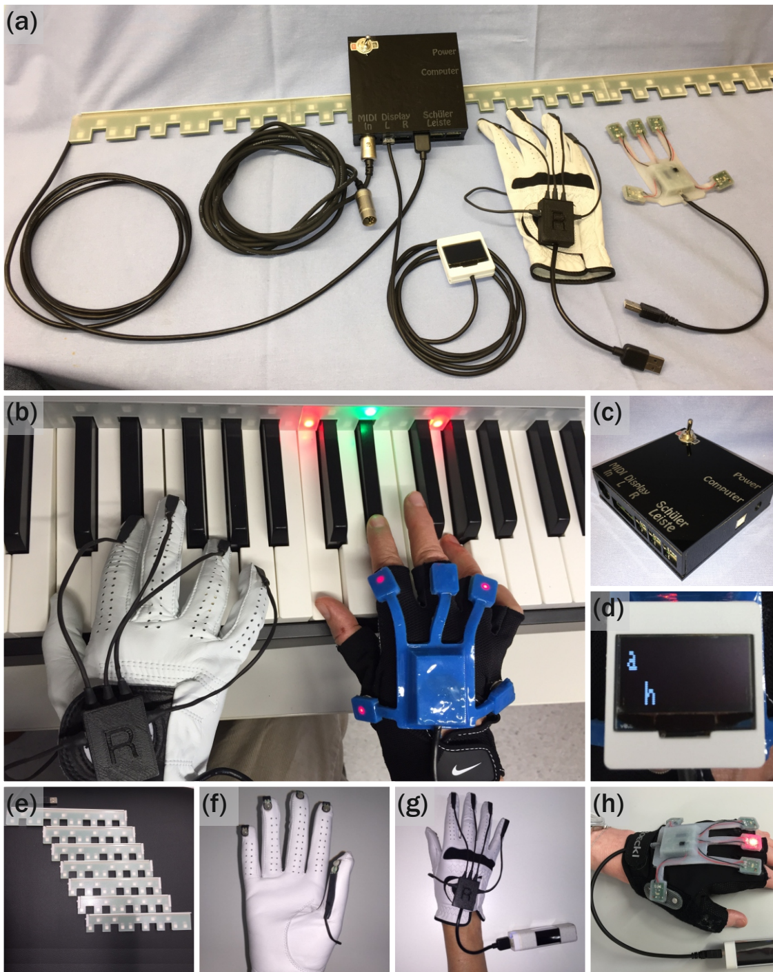
Abbildung 3.3: Übersicht über das Klaviertrainingsystem. (a) Kontrolleinheit mit allen angeschlossenen Elementen. (b) Der Lehrer (links) stimuliert durch Tastendruck die Finger des Schülers (rechts) und beleuchtet seine Taste. (c) Kontrolleinheit mit benötigten Anschlüssen. (d) Das Display übersetzt die gespielten Noten in Buchstaben. (e) Fragmentierbare LED-Leiste für den besseren Transport. (f) Lehrerhandschuh mit Drucksensoren in den Fingerspitzen. (g) Lehrerhandschuh von oben mit angeschlossener Powerbank. (h) Schülerhandschuh mit Elektronik zur Stimulation und angeschlossener Powerbank.
