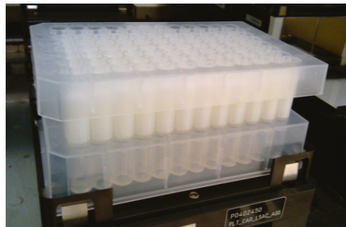
Abb. 10. Gelfiltrationsplatte im 96-well Format. Eine vorgefertigte 96-well Gelfiltrationsplatte wurde mit Superdex 75 Material befüllt (Säulenvolumen ca. 1 ml) und mit Filterplättchen abgedichtet.
