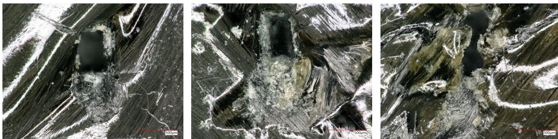
a) b) c) Abbildung 4-19: Ansichten von Laminatbruchflächen nach Auszug der z-Verstärkung durch Scherung; a) nasschemisch vorbehandelt (X5CrNi18-10) und gerade Geometrie, b) physikalisch vorbehandelt (Ti-15V-3Cr-3Sn-3Al) und gerade Geometrie, c) mit Trennmittel vorbehandelt (Ti-15V-3Cr-3Sn-3Al) und Hinterschnittgeometrie
