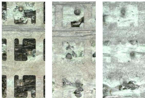
Abbildung 4-24: Frontansichten und Draufsichten von z-Verstärkungen nach Prüfung (100- und 20-fache Vergrößerung respektive)
