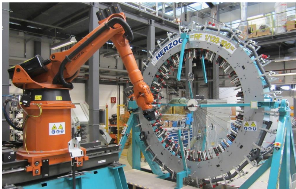
Abb. 2-24: Fertigungszelle für Geflechtpreforms am LCC
