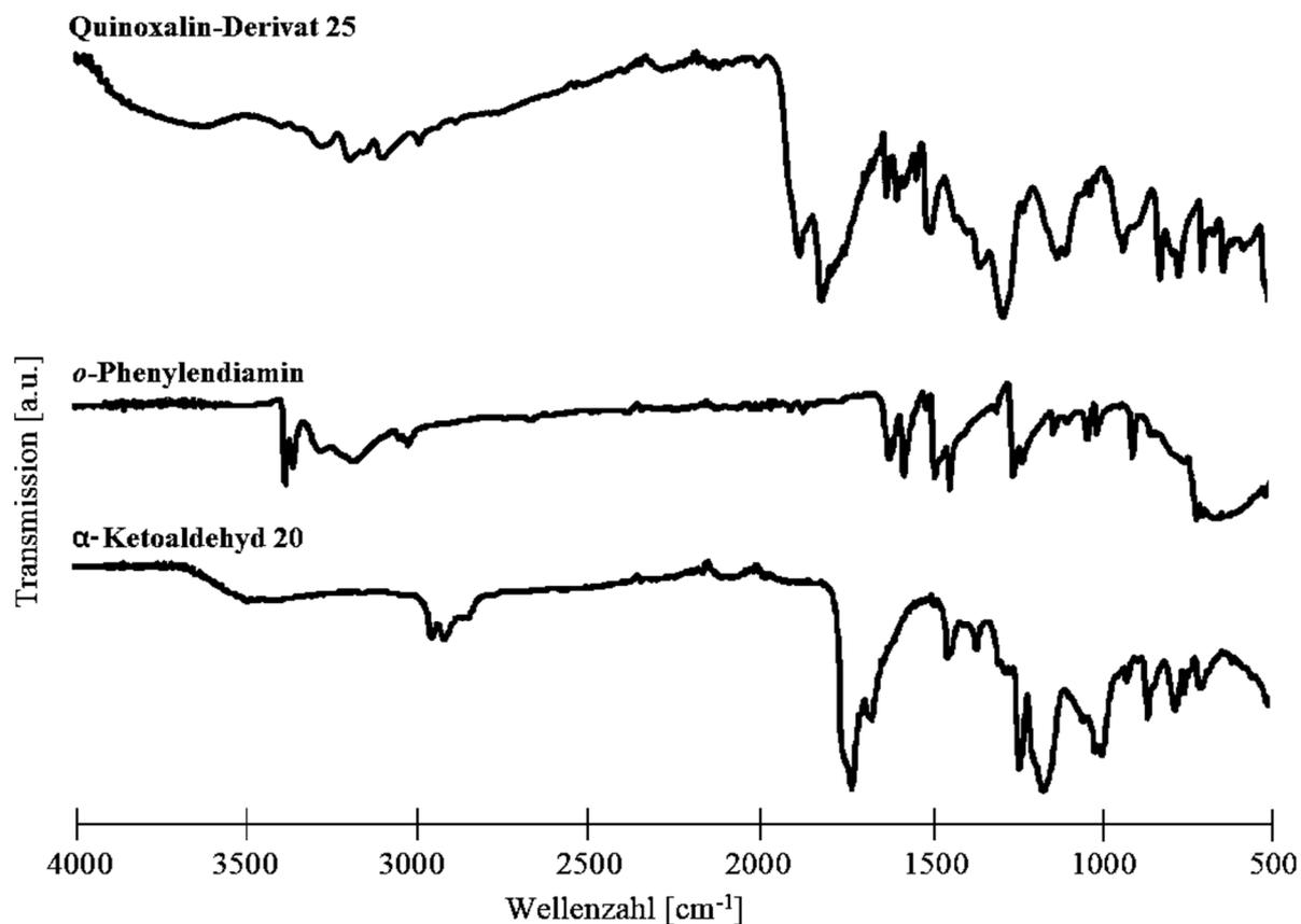
**Abb. 4.21:** Vergleich der FTIR-Spektren der Edukte (*o*-Phenylendiamin, α-Ketoaldehyd **20**) und des Produktes (Quinoxalin-Derivat) der ersten Modellreaktion.
