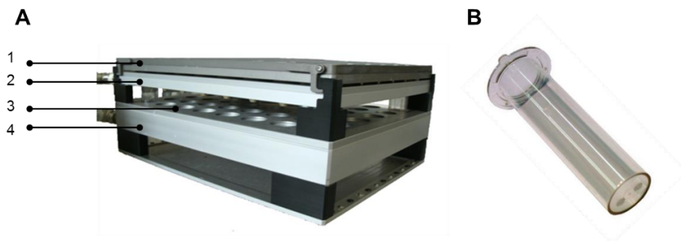
Abbildung 4.2: A) Aufbau des 48-fachen Bioreaktorblocks. (1) Deckel mit Öffnungen für Probenahme und Zudosierung, (2) Kopfraumkühlung, (3) Öffnungen für die Milliliter-Bioreaktoren, (4) integrierter Wärmetauscher für die Kontrolle der Prozessstemperatur und magnetisch induktiver Antrieb für die Rührer. B) Unbewehrter Milliliter-Bioreaktor. Am Boden sind die Plätze für die optionale Anbringung von polymerbasierten Sensoren für die pH- beziehungsweise \text{O}_2 -Messung zu sehen.
