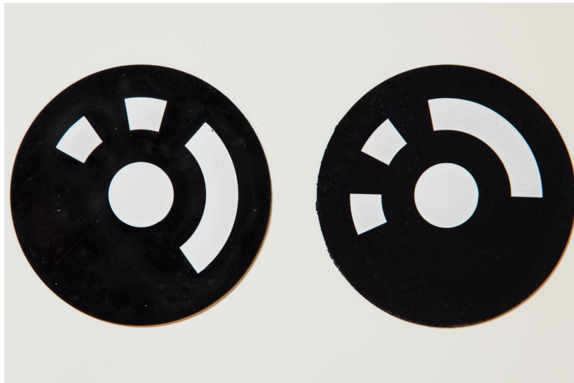
Abbildung A.10: Vorderseite der codierten Targetvariante mit zusätzlichem schwarzem Rand für die mehrmalige Verwendung.
