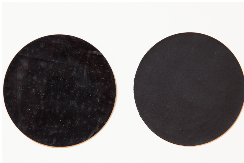
Abbildung A.11: Rückseite der codierten Targetvariante mit zusätzlichem schwarzem Rand für die mehrmalige Verwendung. Die Verwendung einer Abdeckfolie (links) führt zu einer glatten Oberfläche, ohne Folie entsteht eine diffuse, raue Oberfläche (rechts).
