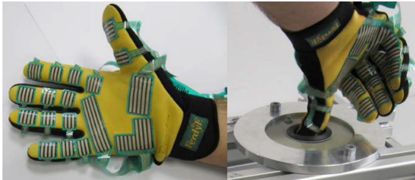
Abbildung 14: Einsatz des Druckmesshandschuhs Grip™ der Firma Tekscan® zur Ermittlung der Aktionskräfte beim Verbau von Stopfen (Abbildung aus Walther & Gerhard, 2014)
