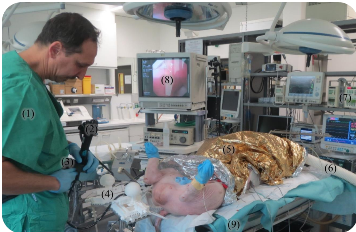
Abb. 98: Aufbau des Tierversuchs: (1) Operateur; (2) Endoskop; (3) Haltegurt; (4) Manipulatorsystem; (5) Heizdecke; (6) Warmluftzufuhr; (7) Anästhesie-Geräte; (8) Bildschirm für Endoskopbilder; und (9) Operationstisch.
