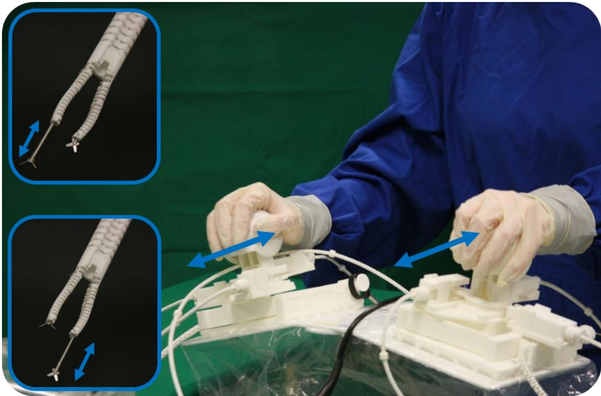
Abb. 85: Die Instrumente lassen sich in den Führungskanälen des Systems geradlinig (translatorisch) vor und zurück bewegen. Diese Bewegung wird durch horizontales Bewegen der Kugeln erreicht.
