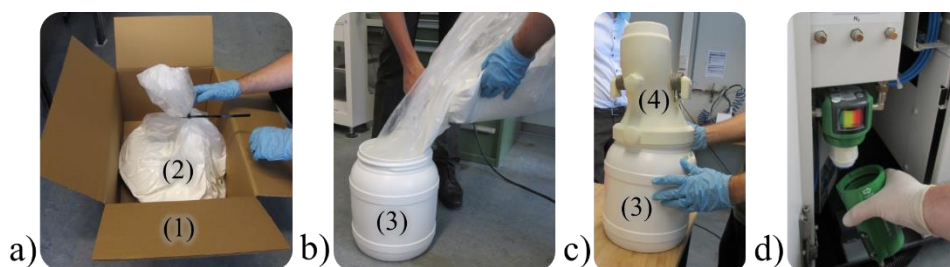
Abb. 103: Öffnen des neuen Kartons (1) (a) und Entnahme des Anlieferungssackes (2); b) direktes Einfüllen des Neupulvers in den Vorratsbehälter (3) der Maschine; c) verschließen des Behälters mit dem Trichter (4) für die Maschine; d) überprüfen der Filteranlage (5).
