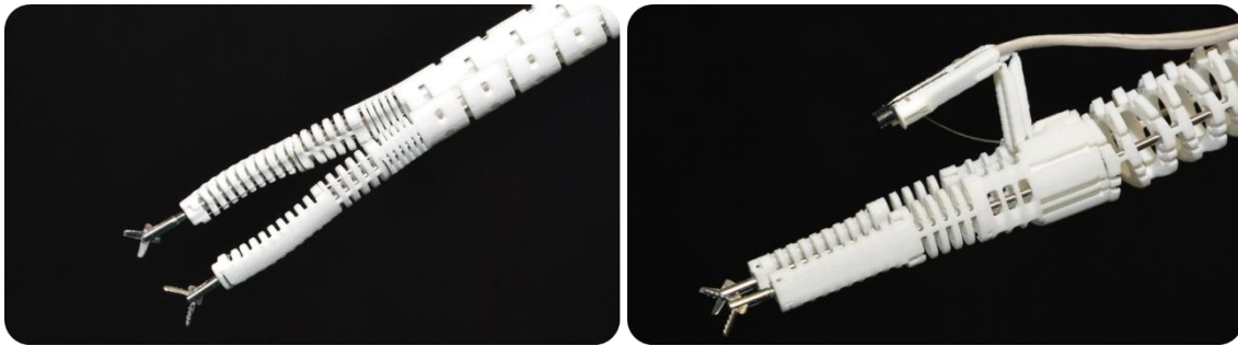
Abb. 55: Manipulatorenarme mit eingeführten Greifinstrumenten, links starres HNO-System; rechts flexibles gastroenterologisches System mit aufgestelltem Kameraarm.
