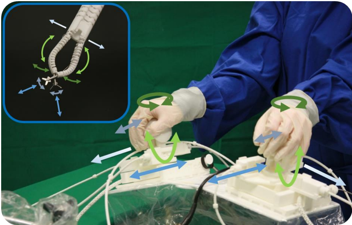
Abb. 92: Kombinierte Bewegungen der einzelnen Freiheitsgrade. Durch die Kombination der Freiheitsgrade wird der Arbeitsraum der Arme vergrößert und Kombinierte Bewegungen in denen mehrere Freiheitsgrade angesteuert werden, wie z.B. kreisförmige Bewegungen lassen sich realisieren.
