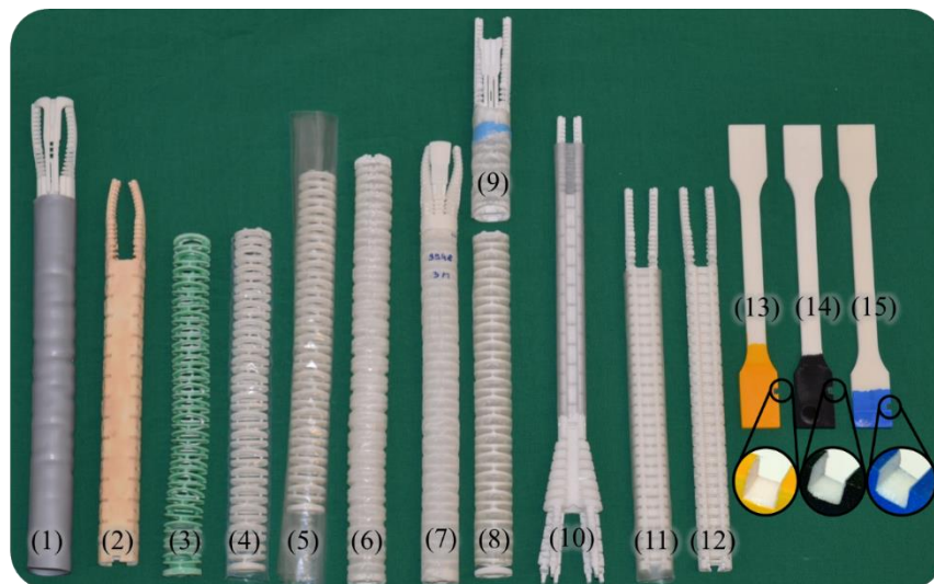
Abb. 71: Ummantelungen des Systems: (1) Schumpfschlauch (Lebensmittelecht, nicht biokompatibel); (2) Latex-Milch; (3) Fegura-Sil; (4) Schumpfschlauch PTFE; (5) Abdeckfolie OP; (6) Parafilm Verschlussfolie; (7) Inzisionsfolie 3M mit PA2200 Pulver bestäubt (8)-(9) Inzisionsfolie 3M; (10) 3D-gedruckte Hülle (Form 1+, Flexible); (11) Silikonschlauch; (12) mit Klarlack (Hesse MEGA-PUR) lackiertes System; (13)-(15) Zug-Prüfstäbe eingetaucht in Lack (Hesse MEGA-PUR) und Detailsaufnahmen von eingefrästen Nuten.
