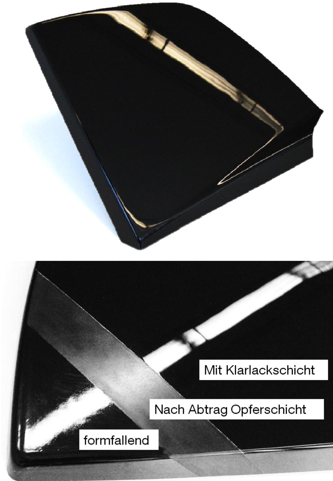
Abb. 96: oben: Technologiedemonstrator; unten: Oberflächen des Technologiedemonstrators: formfallend, nach Abtrag und nach Auftrag einer Klarlackschicht
