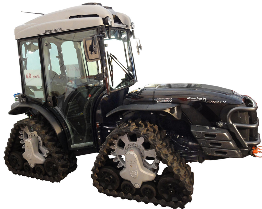
Abbildung 2.1: Schmalspurschlepper auf vier Kettenlaufwerken und mit Knicklenkung, seit 2010 am Markt.
