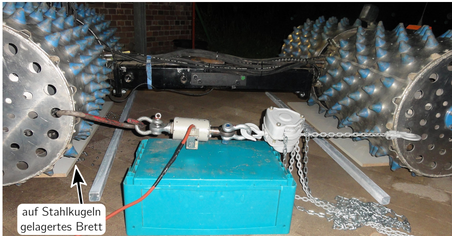
Abbildung 3.23: Versuchsanordnung für den Seitenzugversuch. Die beiden Antriebsachsen werden seitlich zusammengezogen. Um in alle Richtungen frei beweglich zu sein, stehen sie dabei auf Brettern, welche auf Stahlkugeln liegen.
