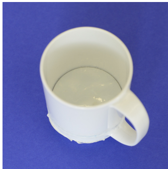
Abbildung 10 Becher mit Trennfolie, um die Gewichtskraft von Flüssigkeiten auf eine flexible Platte zu leiten und die Elektronik vor Feuchtigkeit zu schützen.
