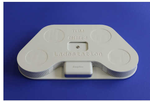
Abbildung 28 Exemplarische Umsetzung einer Mehrfachladestation mit Akku und abgesenkten Flächen für vier Detektionsbecher.
