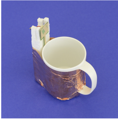
Abbildung 18 Funktionsmuster zur Füllstandbestimmung auf Basis eines kapazitiven Sensors, welcher die Gesamtkapazität innerhalb des Bechers mit der Umgebung vergleicht.
