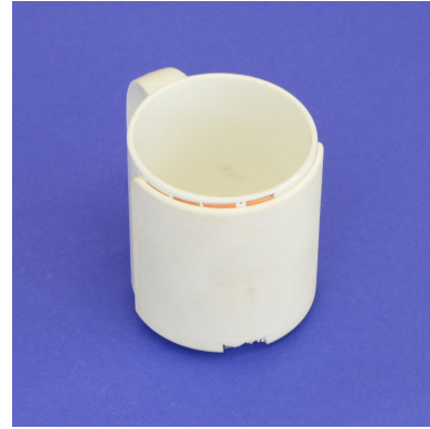
Abbildung 19 Funktionsmuster zur Füllstandbestimmung auf Basis eines kapazitiven Sensors mittels referenzierter Kapazität.
