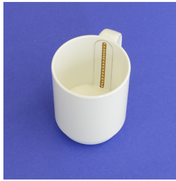
Abbildung 14 Funktionsmuster zur Füllstandbestimmung auf Basis der Leitfähigkeit mit Sensorelektroden in Form von mit Gold beschichteten Flächen auf einer flexible Leiterplatine.
