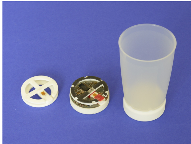
Abbildung 9 Funktionsmuster einer unterhalb eines Bechers befestigten Waage. Eine um einen Biegebalken aufgebaute Mechanik (links) verbindet eine Plattform für einen Becher mit dem Boden, in welchem sich die Auswerteelektronik (mitte) befindet. Sie wird unterhalb eines Bechers befestigt (rechts).
