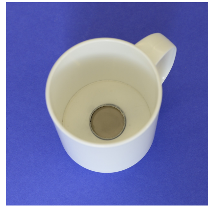
Abbildung 6 Funktionsmuster zur Füllstandbestimmung auf Basis eines hydrostatischen Drucksensors.
