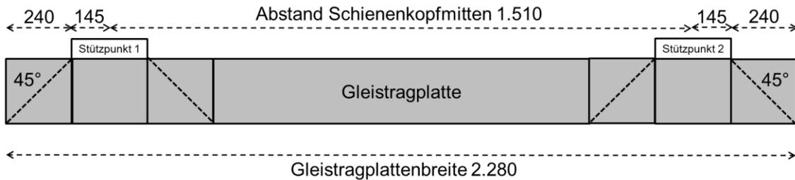
**Abbildung 39: Geometrische Betrachtung der GTP-Breite (schematischer Querschnitt; Angaben in [mm])**
