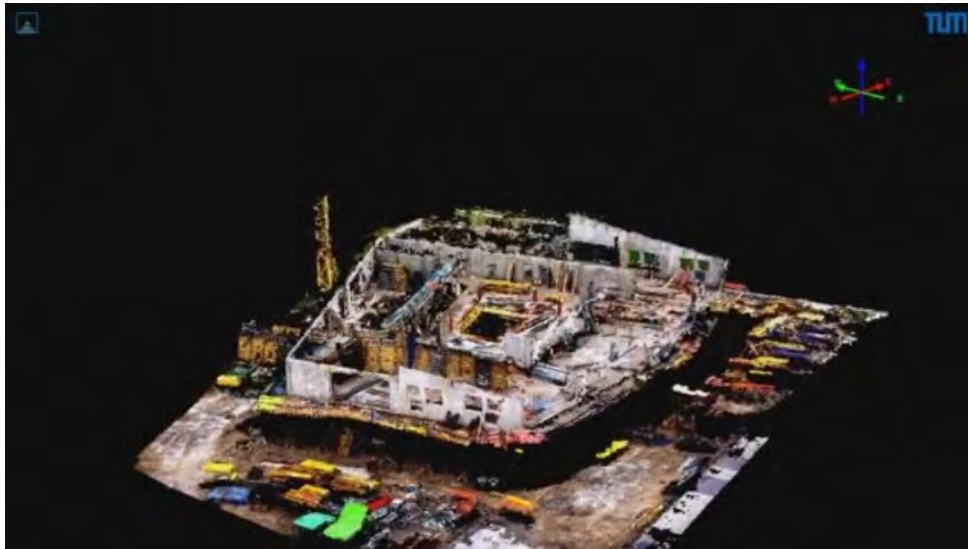
Abbildung 13 Die fertig generierte, strukturierte Punktwolke ( https://www.cms.bgu.tum.de/de/forschung/projekte/progresstrack , abgerufen am 31. März 2016)
