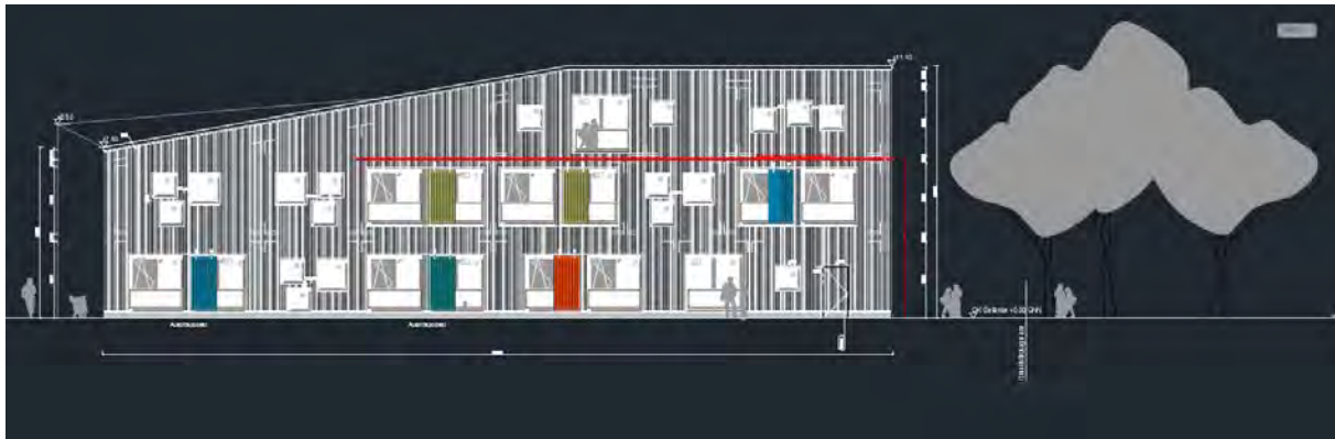
Abbildung 28 Ansicht HfK: Fenster der Position 4 sind teilweise mit bunten Verschalungen verkleidet (h4a Architekten)
