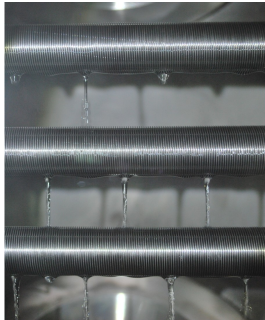
Abbildung 7.4: Säulenförmiges Abtropfverhalten bei der Kondensation am Rohrbündel
