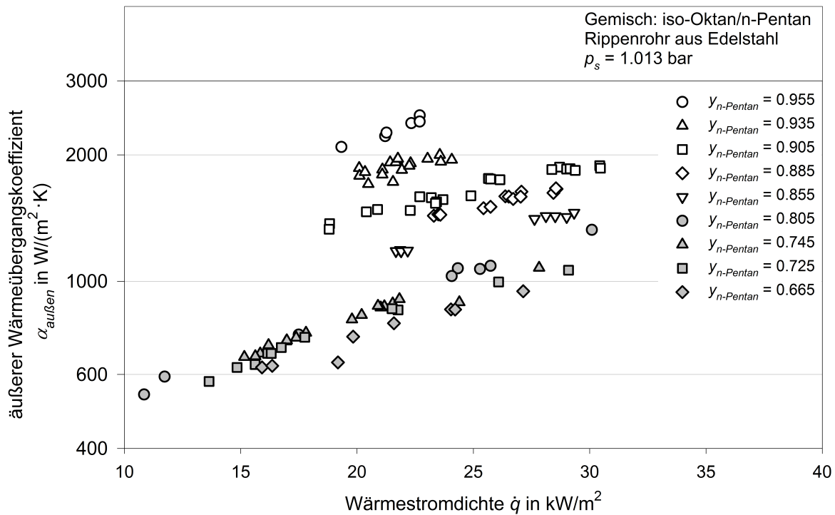
Abbildung 5.5: Äußerer Wärmeübergangskoeffizient aufgetragen über der Wärmestromdichte für die Kondensation des Gemisches iso-Oktan/n-Pentan an einem Edelstahl Rippenrohr bei unterschiedlichen Gemischzusammensetzungen
