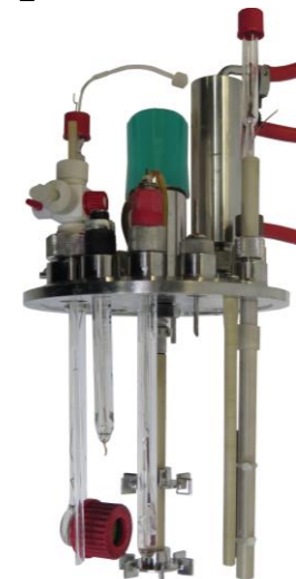
Abbildung 24 Modifizierter 3,6 L-Rührkesselreaktoren für die Verwendung als bio-elektrochemischer Reaktor. (A) Versuchsaufbau. [1] Potentiostat; [2] Luftbefeuchtung Kathodenkammer; [3] Luftbefeuchtung Reaktor; [4] Antischaumfalle; [5] Waage; [6] Reaktor; [7] Rührer; [8] Säure; [9] Mediator; [10] Base. (B) Schematische Darstellung. Die Farbcodierung und Beschriftungen entsprechen den für den 1,8 L Reaktor (Abbildung 23) beschriebenen. Redox: Redox-Sonde; Mediator: Mediatorzulauf zur Regelung des Redoxpotentials des Mediums. (C) Foto des zusammengebauten 3,6 L-Reaktors. (D) Foto des Deckels des 3,6 L-Reaktors mit Modifikationen - Aufsicht. (e) Foto des Deckels des 3,6 L-Reaktors mit Modifikationen - Seitenansicht.
