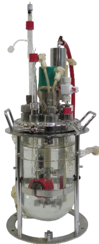
Abbildung 23 Modifizierter 1,8 L-Rührkesselreaktoren für die Verwendung als bio-elektrochemischer Reaktor. (A) Versuchsaufbau. [1] Potentiostat; [2] Luftbefeuchtung Kathodenkammer; [3] Luftbefeuchtung Reaktor; [4] Antischaumfalle; [5] Waage; [6] Reaktor, [7] Rührer; [8] Säure; [9] Base. (B) Schematische Darstellung. AE: Arbeitselektrode; RE: Referenzelektrode; GE: Gegenelektrode; pH: pH-Sonde. Zur Modifikation verwendete Materialien sind über folgende farbliche Kodierungen gekennzeichnet: Rot: Glas; Grün: PEEK; Blau: PVC und Silikon. (C) Foto des zusammengebauten 1,8 L-Reaktors. (D) Foto des Deckels des 1,8-L Reaktors mit Modifikationen - Aufsicht. (E) Foto des Deckels des 1,8 L-Reaktors mit Modifikationen - Seitenansicht.
