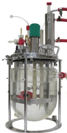
Abbildung 24 Modifizierter 3,6 L-Rührkesselreaktoren für die Verwendung als bio-elektrochemischer Reaktor. (A) Versuchsaufbau. [1] Potentiostat; [2] Luftbefeuchtung Kathodenkammer; [3] Luftbefeuchtung Reaktor; [4] Antischaumfalle; [5] Waage; [6] Reaktor; [7] Rührer; [8] Säure; [9] Mediator; [10] Base. (B) Schematische Darstellung. Die Farbcodierung und Beschriftungen entsprechen den für den 1,8 L Reaktor (Abbildung 23) beschriebenen. Redox: Redox-Sonde; Mediator: Mediatorzulauf zur Regelung des Redoxpotentials des Mediums. (C) Foto des zusammengebauten 3,6 L-Reaktors. (D) Foto des Deckels des 3,6 L-Reaktors mit Modifikationen - Aufsicht. (e) Foto des Deckels des 3,6 L-Reaktors mit Modifikationen - Seitenansicht.
