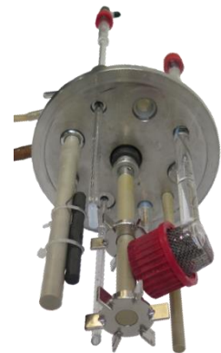
Abbildung 23 Modifizierter 1,8 L-Rührkesselreaktoren für die Verwendung als bio-elektrochemischer Reaktor. (A) Versuchsaufbau. [1] Potentiostat; [2] Luftbefeuchtung Kathodenkammer; [3] Luftbefeuchtung Reaktor; [4] Antischaumfalle; [5] Waage; [6] Reaktor, [7] Rührer; [8] Säure; [9] Base. (B) Schematische Darstellung. AE: Arbeitselektrode; RE: Referenzelektrode; GE: Gegenelektrode; pH: pH-Sonde. Zur Modifikation verwendete Materialien sind über folgende farbliche Kodierungen gekennzeichnet: Rot: Glas; Grün: PEEK; Blau: PVC und Silikon. (C) Foto des zusammengebauten 1,8 L-Reaktors. (D) Foto des Deckels des 1,8-L Reaktors mit Modifikationen - Aufsicht. (E) Foto des Deckels des 1,8 L-Reaktors mit Modifikationen - Seitenansicht.
