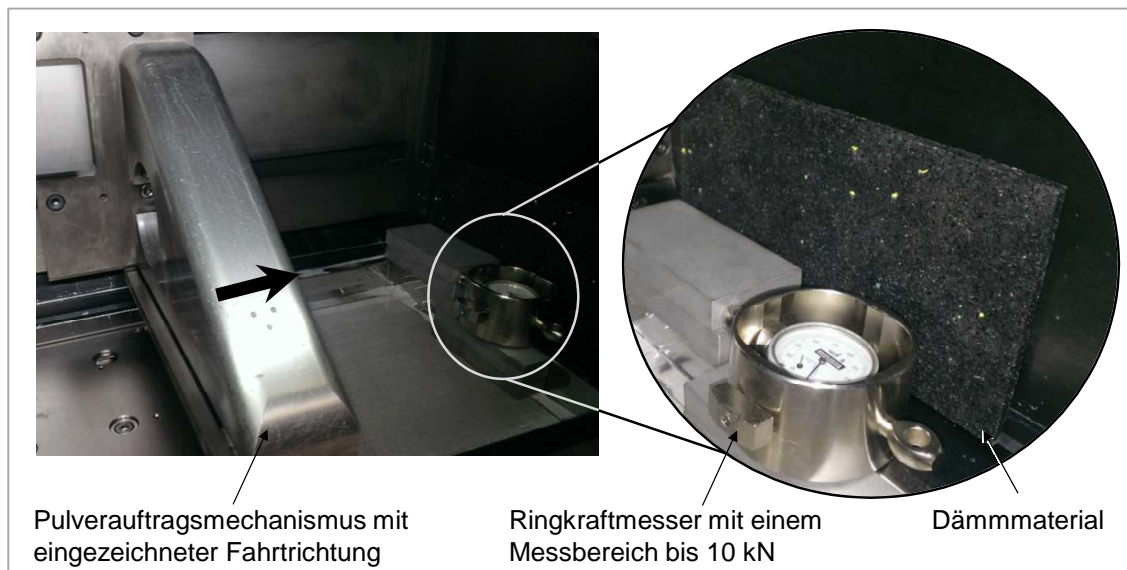
Abbildung 5-11: Versuchsaufbau zur experimentellen Ermittlung der Antriebskraft des Pulverauftragsmechanismus, durchgeführt auf der Laserstrahlschmelzanlage EOS M270
