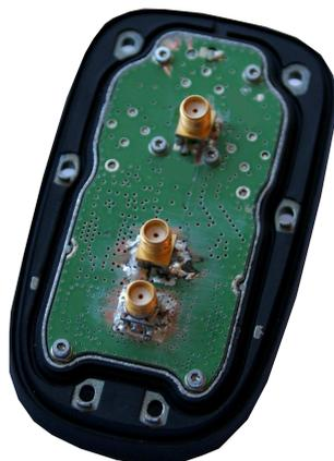
**Bild 4.12.:** Dachantenne mit entfernten Antennen für die Messung der Streuparameter der Schaltungen
