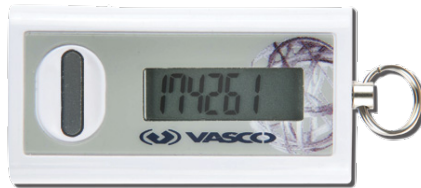
Abb. A.4: Der Token stellt den Faktor Besitz bei der Authentifizierung bereit
