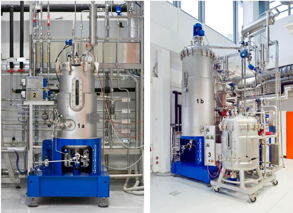
**Abbildung 4.4:** Bioreaktoren im TUM-Forschungszentrum für Weiße Biotechnologie: (1 a) Edelstahlrührkesselreaktor mit einem Nominalvolumen von 75 L, (1 b) Edelstahlrührkesselreaktor mit einem Nominalvolumen von 1 500 L, (2) Pumpen für die Zufuhr von Titrationsmitteln, Substratlösungen und Antischaummitteln, (3) Steuereinheit für die Messung und Regelung von Drehzahl, Druck, pH, Sauerstoffpartialdruck und Temperatur.
