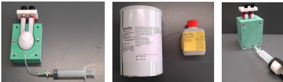
Abbildung 2.40: Einspritzen der 2-K-Abformmasse in die Gussform
