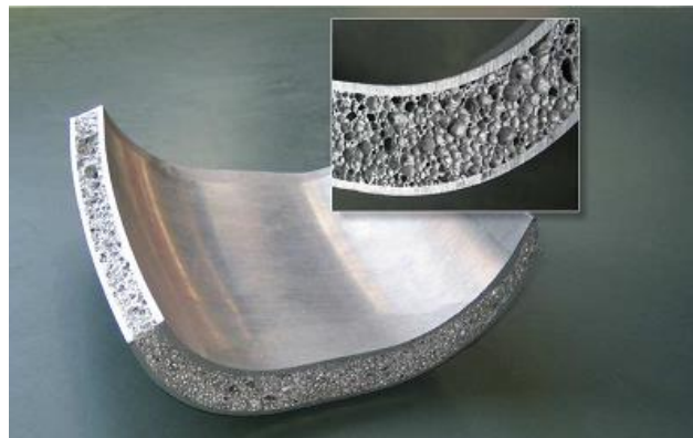
Abbildung 2-10: Aufgeschäumtes Sandwichbauteil (SVIRIDOV 2011)
