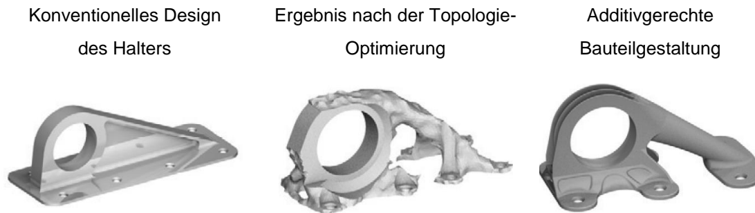
Abbildung 2-20: Leichtbauoptimierung eines Halters (in Anlehnung an EMMELMANN ET AL. (2011A))
