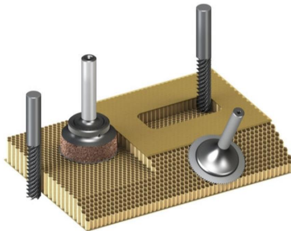
Abbildung 2-22: Uniform ausgerichteter Wabenkern nach der Fräsbearbeitung (HARDING 2015)
