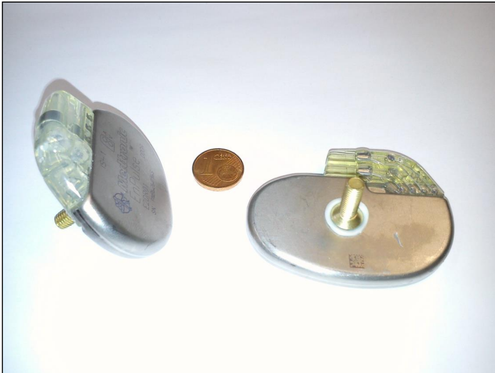
Abb. 3: Beispiel zweier verwendeter Schrittmacher. Beide sind in der Mitte der Rückfläche mit einer M5-Gewinde-Schraube beklebt.
