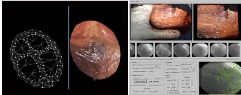
Abbildung 12. (a) Feder-Masse-Modell zur Organmodellierung als Hilfsmittel zur Vorausschau. (b) Bildschirmabzug des Werkzeugs zur Segmentierung von Angiographiebildern.
