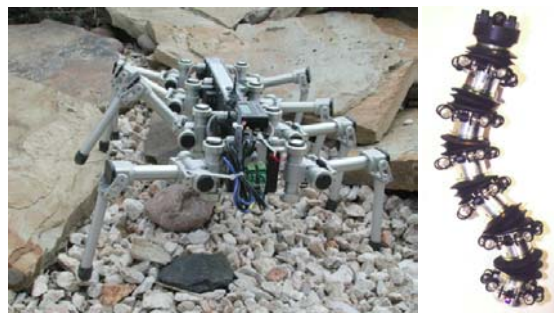
Abbildung 3. Beispiele für Spezialbauformen zur besseren Adaptation an die Umwelt. Einsatz im Freien mit dem Ziel der Minenräumung bzw. der Kanalinspektion (beide Fraunhofer-AiS).
