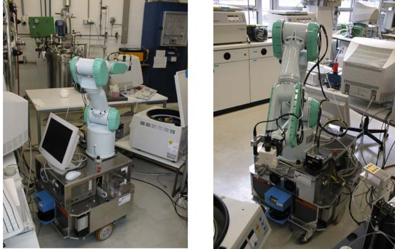
Abbildung 9. Mobiler Manipulator. (a) Rückansicht mit hinterem Laserscanner. (b) Frontansicht mit Greifer und Kamera.
