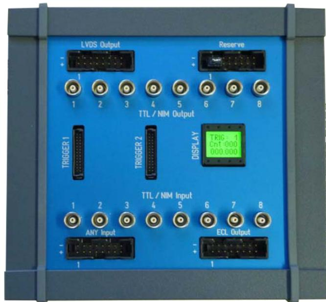
Abbildung 3.6: Anschlüsse des EXPLODERs
