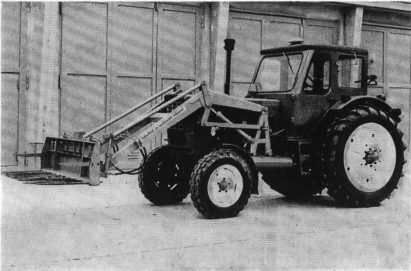
Frontlader T 182 zum Traktor MTS-50
