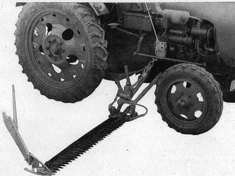
Anbaumähwerk Typ E 092/1 mit Schneidwerk
