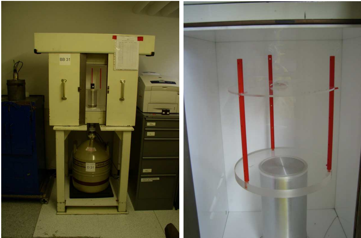
Abbildung 6.1: Links: Foto des stationären HPGe-Detektorsystems mit geöffneter Blei-Abschirmung, mit der RCM-internen Bezeichnung Det 31. Rechts: Auf die Detektorendkappe aufgesetzter Probenhalter. Auf diesem liegen zwei Amersham-Punktquellen nebeneinander und darauf ein doppelt in Folie eingeschweißtes Tm 2 O 3 Pulver.
