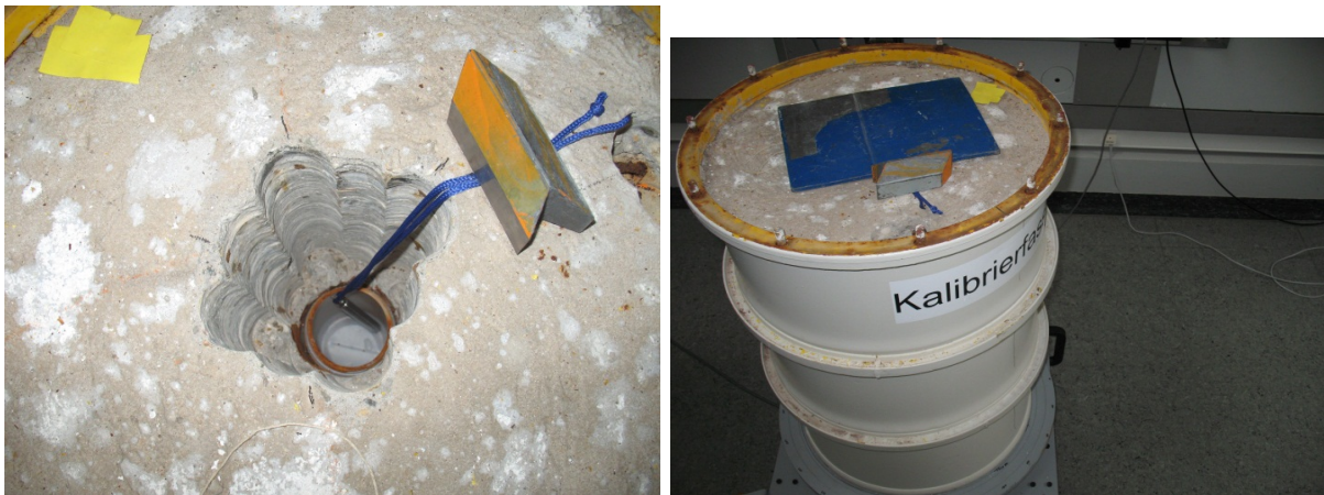
Abbildung 6.19: Betonfass mit Bohrloch. Links: Am unteren Ende der blauen Schnur ist die ^{90}\text{Sr} -Stabquelle befestigt. Rechts: Bleiplatte als Deckel für das Bohrloch.
