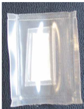
Abbildung 6.7: Foto der eingeschweißten \text{Tm}_2\text{O}_3 -Probe mit dem aktivierten \beta -Strahler ^{170}\text{Tm} .
