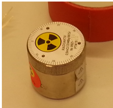
Abbildung 6.9: Foto des Aufbewahrungsbehälter mit ^{90}\text{Sr} -Kalibrationspunktquelle.
