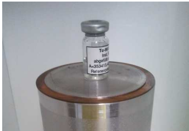
Abbildung 6.15: Das Glasfläschchen mit der ^{99}\text{Tc} -Lösung auf der Detektor-Endkappe stehend. Zwischen Endkappe und Fläschchen sind die Aluminium- und die Kupferplatte platziert.
