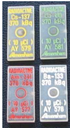
Abbildung 6.6: Foto eines Sets mit vier Punktstrahler. Von oben links nach unten rechts: ^{137}\text{Cs} , ^{60}\text{Co} , ^{241}\text{Am} und ^{133}\text{Ba} .
