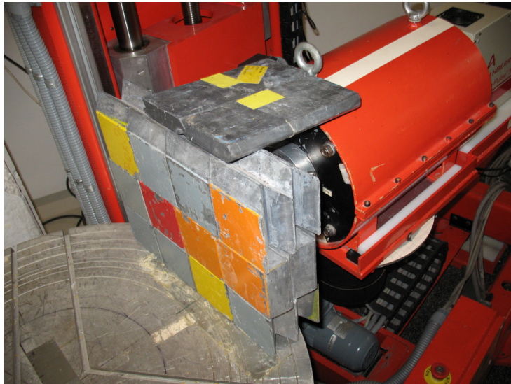
Abbildung 6.11: Foto des Messaufbaus für die Messung des Untergrundbeitrages mit dem MGS-1. Durch die Blei-Wand vor dem Kollimator wird in dieser Messung nur der Anteil, der den Detektor von hinten trifft, berücksichtigt.
