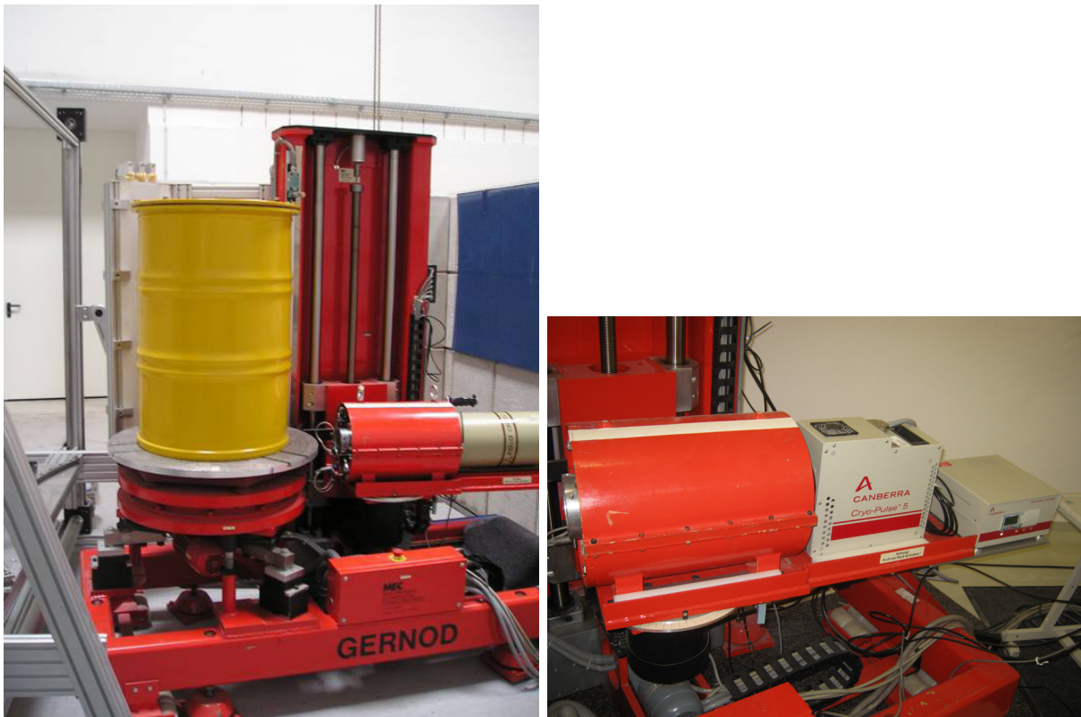
Abbildung 6.4: Links: Foto des mobilen \gamma -Scanners MGS-1 während der Messung eines 200 L Fasses. Das Foto zeigt noch den alten Stickstoff-gekühlten HPGe-Detektor. Rechts: Foto des neuen Detektorsystems des mobilen \gamma -Scanners MGS-1. Komponenten von rechts nach links: Steuereinheit für den elektrogekühlten HPGe-Detektor, HPGe-Detektor und zylinderförmiger Blei-Kollimator.
