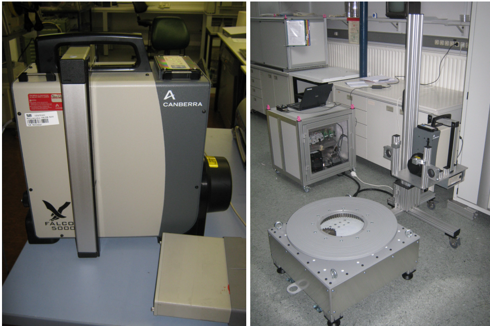
Abbildung 6.2: Links: Foto des mobilen HPGe-Detektors Falcon 5000. Rechts: Im hinteren rechten Teil des Bildes ist der Falcon 5000 auf seinem Sativ montiert.
