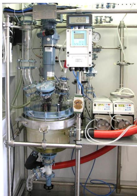
Abbildung 3-1: Syntheseeinrichtung für die Herstellung des \text{Zn}_2\text{Al} -Welan Gum-LDH in größeren Mengen
