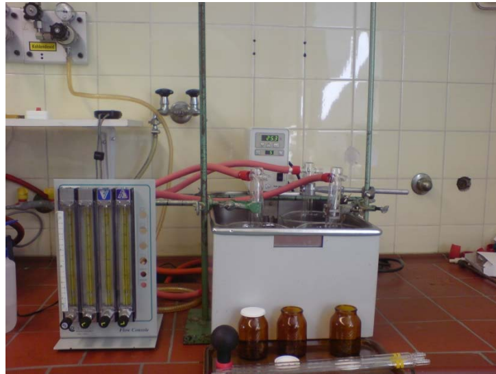
Abbildung 11: Versuchsaufbau für eine simulierte offene Gärung
