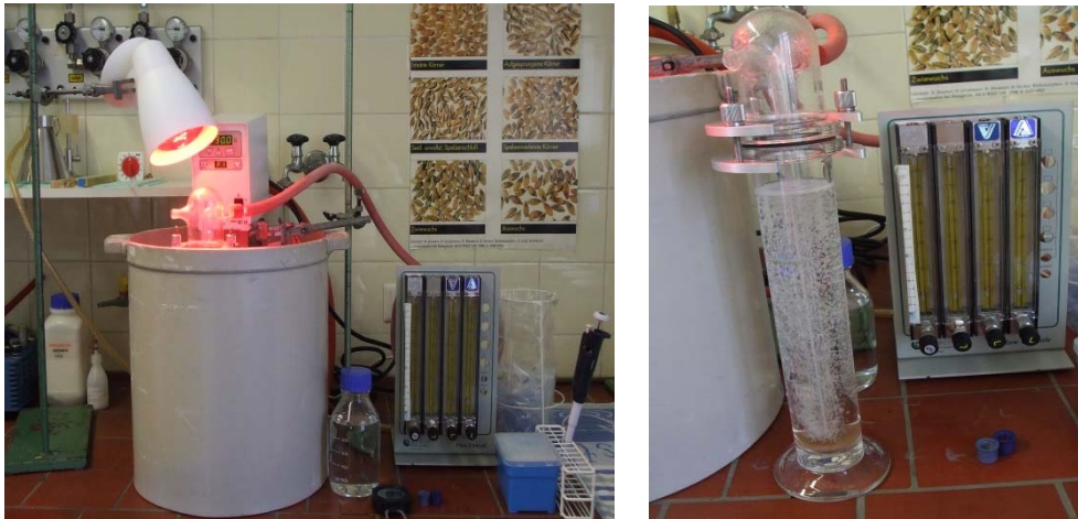
Abbildung 12: Darstellungen des Versuchsaufbaus zur Detektion der relativen Flüchtigkeiten
