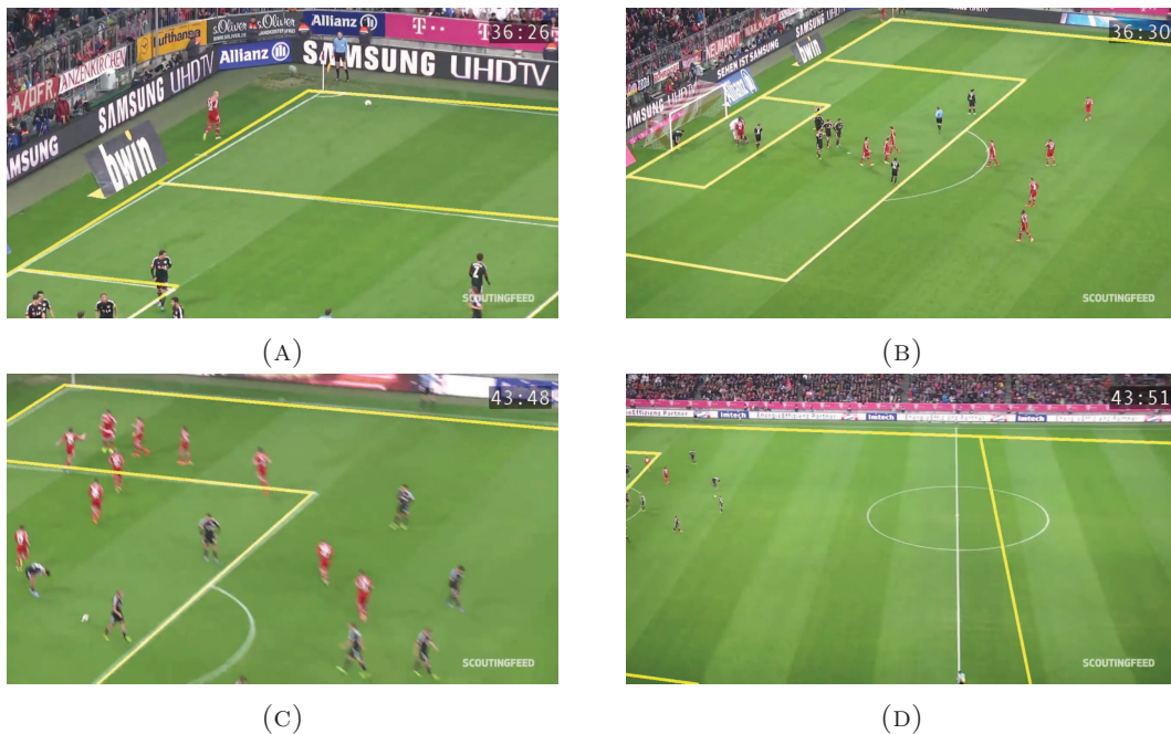
ABBILDUNG 6.17: Begründet durch die automatische Kalibrierung sind Abweichungen infolge von Skalierungen in aller Regel zu vernachlässigen (A, B). Ist keine Neuausrichtung möglich, stellt Bewegungsunschärfe eine zusätzliche Herausforderung dar (C) und kann zu Abweichungen führen (D).
