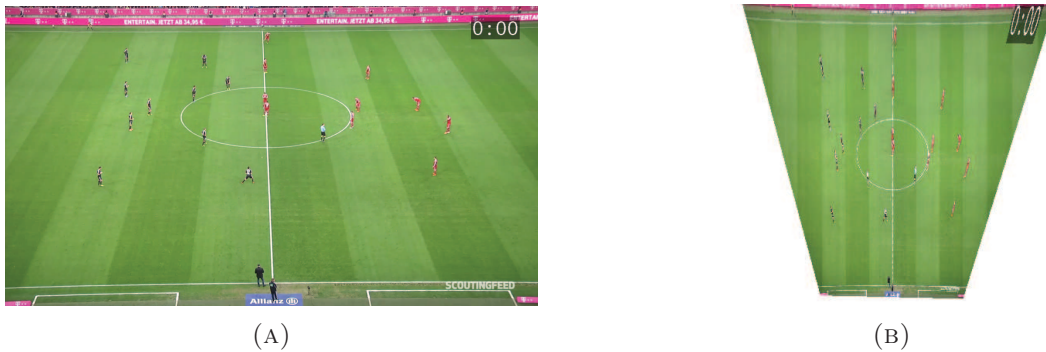
ABBILDUNG 6.1: Rektifizierung. Korrektur der perspektivischen Verzerrung der Spielfeldebene durch eine Homographie, welche die Gerade (in Bild A), in welcher sich parallele Spielfeldlinien schneiden, auf die Gerade l_\infty = (0,0,1)^T , die Gerade im Unendlichen, abbildet (B).
