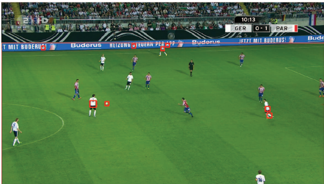
ABBILDUNG 7.2: Ballerkennung innerhalb der Spielfeldhülle unter Ausschluss der Rasenfläche. Bildquelle: [Hopper, 2015, ZDF, 2013a]
