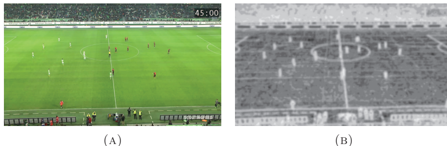
ABBILDUNG 6.8: (A) Bild eines Spielfelds und (B) das Resultat der Berechnung der Entropie in Rechteckfenstern zu jedem Bildpunkt. Zunehmende Helligkeit ist mit einem ansteigendem Wert der Entropie zu interpretieren.
