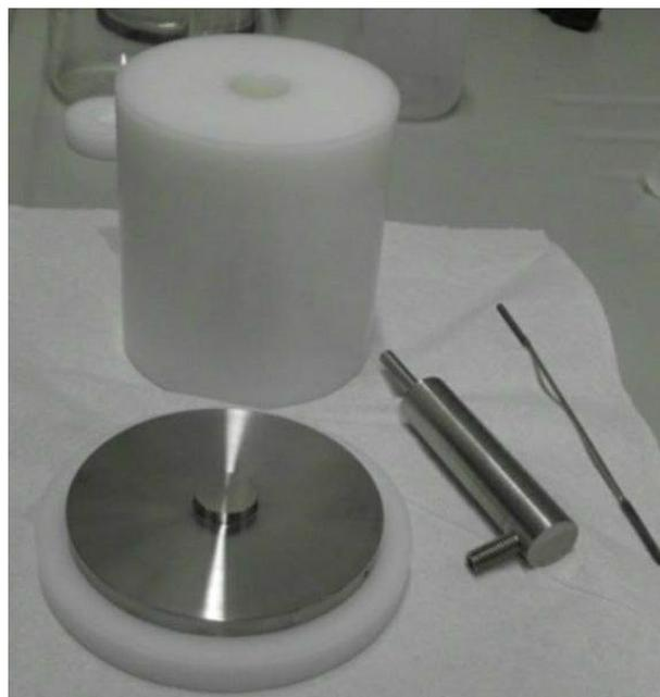
**Abbildung 2.3:** Messwerkzeug zur Bestimmung der elektrischen Leitfähigkeit, das in eine Presse eingespannt und an einem Potenziostaten angeschlossen werden kann.
