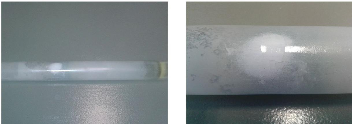
**Abbildung 3.67:** Oxidationsrohr nach der Messung von ca. 150 Li-haltigen Proben. Das Quarzglas ist stark angegriffen und beschädigt.
