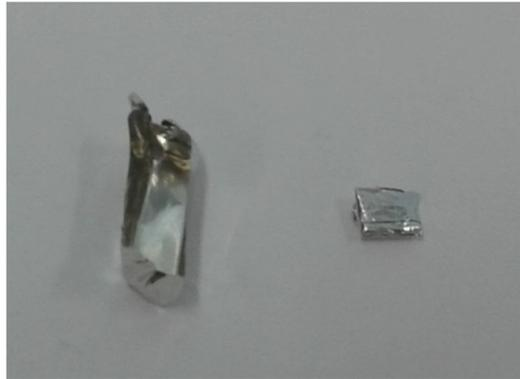
**Abbildung 3.66:** Zinnschiffchen (links) und gefaltetes Zinnschiffchen (rechts).
