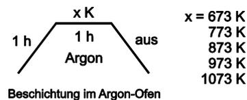
**Abbildung 3.52:** Synthesebedingung von Kohlenstoff-beschichtendem LiCoPO<sub>4</sub> mittels Suspension.
