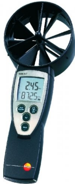
Abbildung 2.1: Beispiel eines Flügelradanemometers: Das Anemometer 417 der Firma Testo. Die Drehzahl des Flügelrades ist proportional zur Anströmgeschwindigkeit (Eckelmann, 1997, 74).
