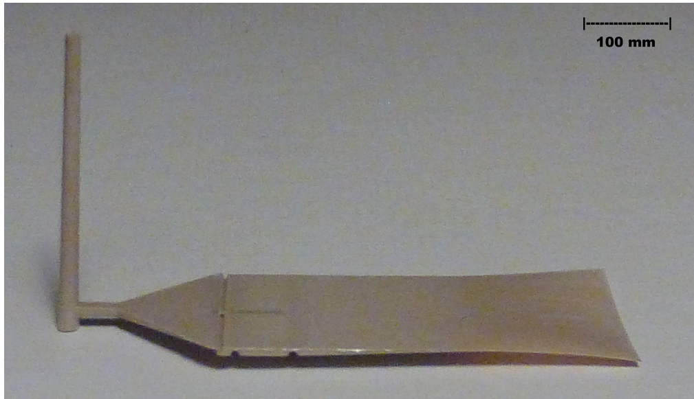
Abbildung 4.20: Spritzgussteil nach der Zeichnung in Abbildung 3.6. Verwerfung im Bereich der Sensorstruktur (rechts im Bild). Dicke des Trägermaterials im Bereich der Sensorstruktur: 0,15 mm.
