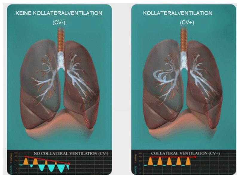
Abbildung 1.6: Messsignal von Luftfluss (orange) und Unterdruck (blau) gemessen im Chartis™-System ohne (links) und mit Kollateralventilation (rechts) (Pulmonx. Inc., 2011).
