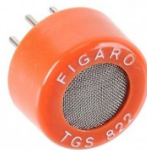
Abbildung 4.38: Der TGS822 Sensor der Firma Figaro USA Inc. Eine Zinnoxidschicht verändert seine Leitfähigkeit in Abhängigkeit von der Sauerstoffkonzentration. Für den optimalen Betrieb wird allerdings der Betrieb eines Heizelementes mit 660mW Leistung nötig (Figaro Inc., 2002, 2).
