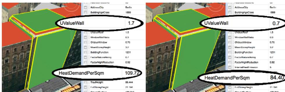
**Abb. 5:** Interaktive Veränderung von Gebäudeparametern (als Folge einer Wärmedämmung) und deren Auswirkungen auf den Energiebedarf. Gezeigt wird eine Szene eines Quartiers in Berlin Moabit.
