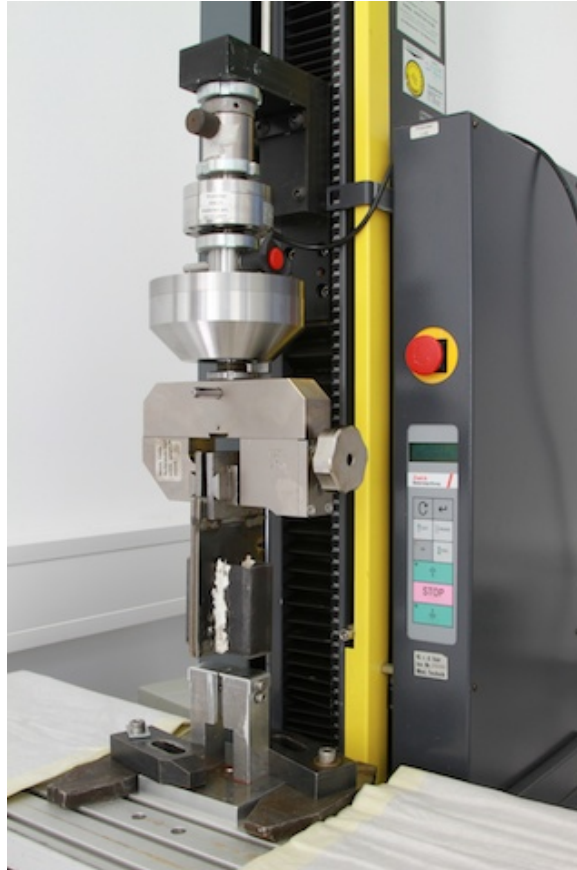
Abbildung 5: Zugprüfmaschine Z 1120 (Firma Zwick, Ulm) und Einspannvorrichtung [eigene Abbildung]
