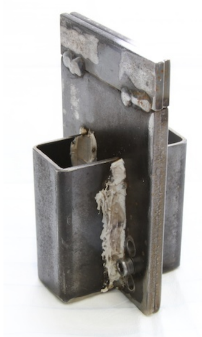
Abbildung 8: Einspanntechnik: proximale Fixierung mittels Kryoklemme [eigene Abbildung]
