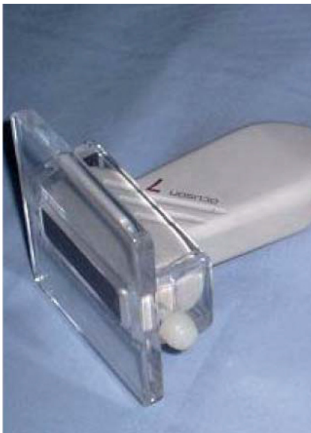
Abbildung 1: Schallkopf mit vergrößerter Auflagefläche zur besseren Penetration bei der "strain elastography" (Doyley et al., 2001)
