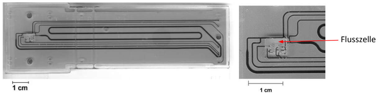
Abbildung 15: Mikrofluidik vom Biacore® 3000 (aus Biacore Sensor Surface Handbook 138 , mit freundlicher Genehmigung von Biacore®).
