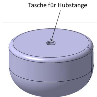
**Abbildung 64: Auftriebskörper mit Tasche für Hubstange**
