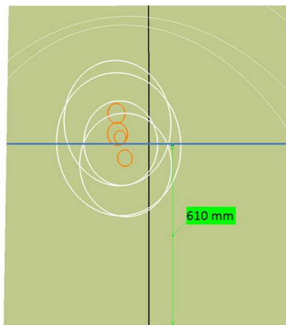
Abbildung 6-8: Vertikale Anzeigehöhe (Unterkante) bei Fokussierung auf den Mittelpunkt zwischen den beiden Gabeln, wobei sich die Gabel auf Höhe des Regalfach 1 befindet; orange definiert die fovealen Sichtbereiche und weiß die parafovealen Sichtbereiche für die vier Extremanthropometrien
