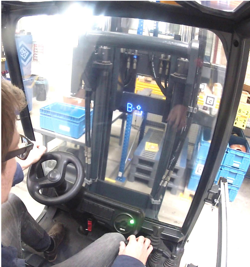
Abbildung 7-8: Hubhöhenanzeige 1: Durch eine Darstellung der korrekten Regalebene (B) des anzufahrenden Lagerplatzes und eines Pfeils wird der Fahrer beim Einstellen der Hubhöhe unterstützt
