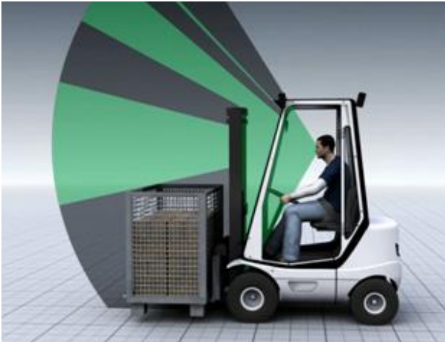
Abbildung 3-8: Sichtfeld eines Staplerfahrers (Quelle: [BGH-2014] )
