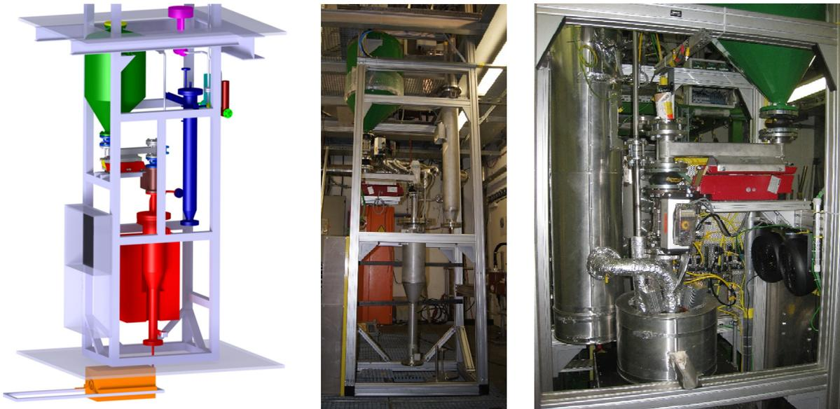
**Abbildung 15: Detailansicht Vergaser (Links: CAD Konstruktion; Mitte: Druckbehälter ohne Isolierung und elektrische Öfen (Stand 2013); Rechts: Detailansicht Vergaserdeckel mit Brennstoffkugelhahn, Vibratorrinne zur Pellet Dosierung und Filter (Stand 2014))**
