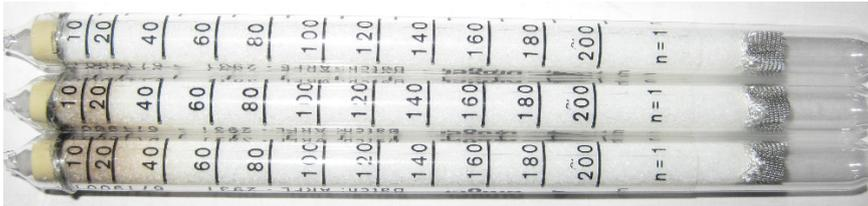
**Abbildung 27: Dräger Röhrchen für H<sub>2</sub>S-Messung mit unterschiedlichen Beladungen**
