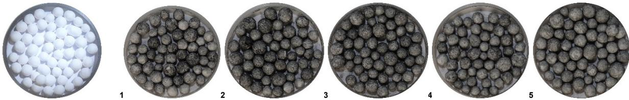
**Abbildung 33: Chloradsorber neu (links) und nach 100h Versuch (1-5 in Durchströmungs-richtung, d.h. 1 = Reaktoreingang, 5 = Reaktorausgang)**
