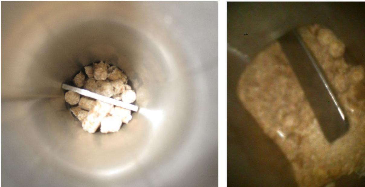
**Abbildung 20: Verstopfung der Pellet Zufuhr (links) und Aufmahlen der Pellets durch den Rührer (rechts)**
