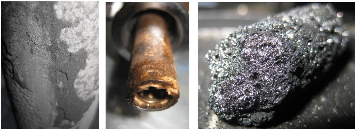
**Abbildung 36: Links: Verspätete Abreinigung und fester Filterkuchen (Bild) lösen beim Abreinigen die Filterhalterung und zerstören die Dichtung (Versuchsabbruch); Mitte: Verstopfen der Analysefilter führt zu kurzen Unterbrechungen in der Gasanalyse; Rechts: Verstopfung der Hauptgasleitung durch „gesinterten“ Restkoks und Bettmaterial (Versuchsunterbrechung).**
