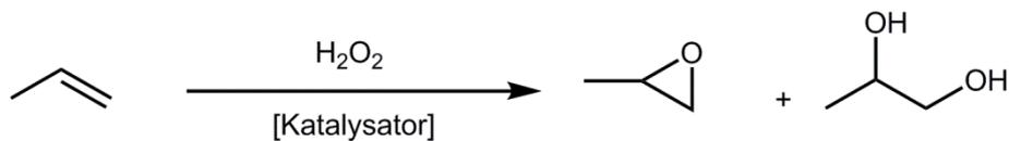
**Schema 4** Schematische Darstellung des HPPO-Verfahrens.
