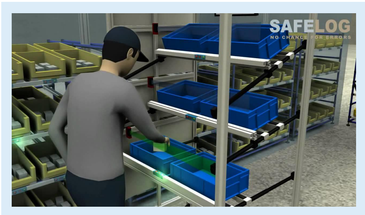
Abbildung 5-8: Zugriffsüberwachung mittels Laserscanner bei Kommissionierung [SAF-2014]
