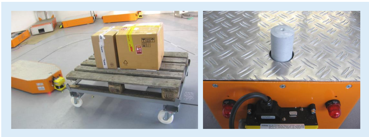
Abbildung 5-12: Fahrerloses Transportfahrzeug mit Unterfahrfunktion [S-E-2011, S. 2ff.]
