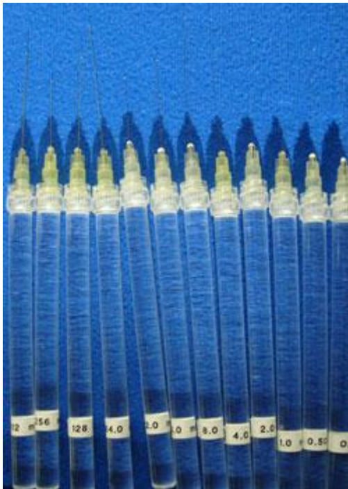
Abbildung 2.2 von Frey-Filamenten (0.25, 0.5, 1, 2, 4, 8, 16, 32, 64, 128, 256 und 512mN) (Quelle: Julian Zimmermann)
