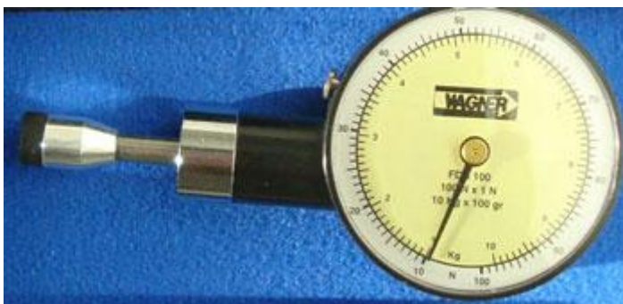
Abbildung 2.5 Druckalgotometer (Quelle: Julian Zimmermann)
