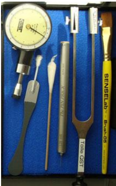
Abbildung 2.4 Set bestehend aus (von links nach rechts) Druckalgometer, Q-Tip, Wattebausch, Nadelreizstimulator, Stimmgabel, Pinsel. (Quelle: Julian Zimmermann)
