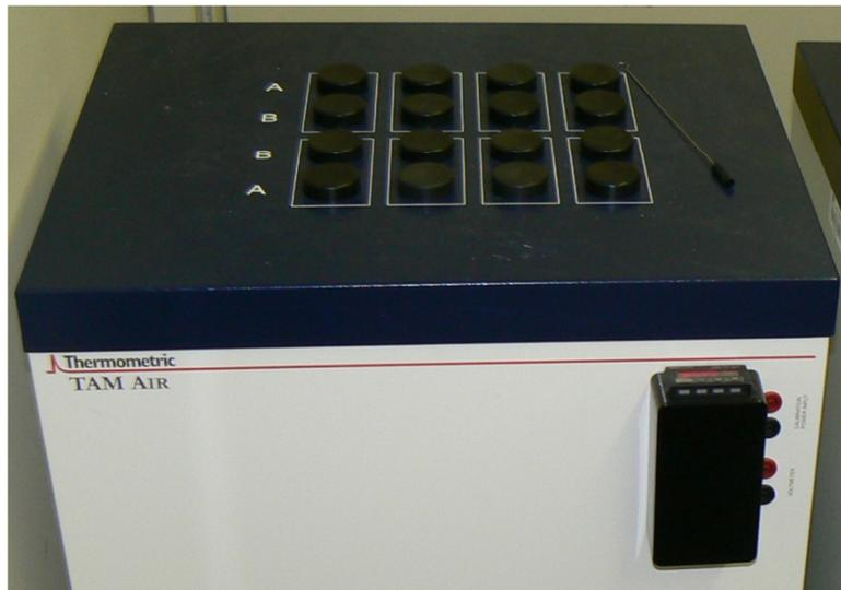
**Abbildung 3-11:** Isothermes Kalorimeter zur Bestimmung der initialen Hydratationsenergie der Zemente
