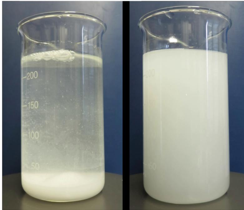
**Abbildung 4-19:** Suspensionen von synthetischem Ettringit, erhalten durch Fällung ohne PCE (links) und mit PCE (rechts) nach Stehenlassen für 2 Minuten. Die großen Kristalle aus der Fällung ohne PCE haben sich vollständig am Boden des Gefäßes abgesetzt, während die Nanokristalle in Gegenwart von PCE gleichmäßig suspendiert bleiben.
