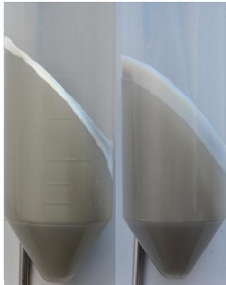
**Abbildung 4-28:** Ettringit-Gel aus CEM I 52,5 R, links entstanden in Anwesenheit des Fließmittels APEG-34, rechts in Anwesenheit des Fließmittels G-MPEG-45.
